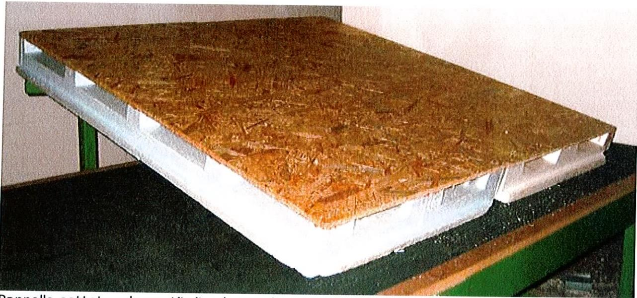
Pannello sottotegola costituito da una lastra di base termoisolante in Polistirene Espanso Sinterizzato spesso Cm.5, sagomato con supporti sporgenti atti a creare canali di ventilazione da Cm.4 + una lastra in legno compresso tipo canadese dello spessore di Cm.1,2
